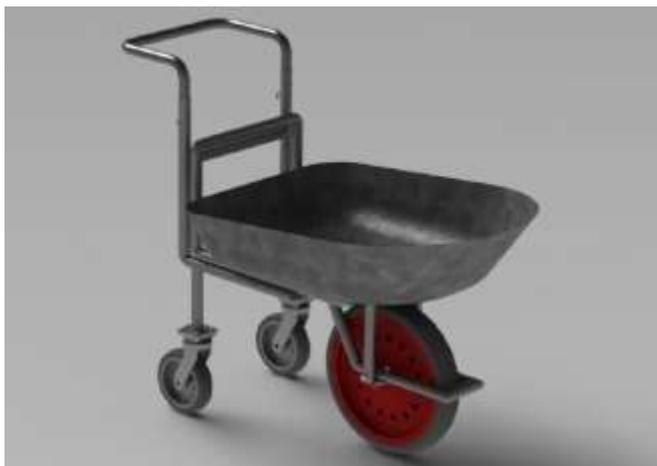
Luego de todos los cambios presentados finaliza la fase de diseño conceptual. Si el Se adopta la propuesta para construir la carretilla ergonómica, se debe continuar con la finalización del proyecto detallado, que debe contener todos los cálculos de resistencia, especificaciones de materiales y todas las dimensiones.
