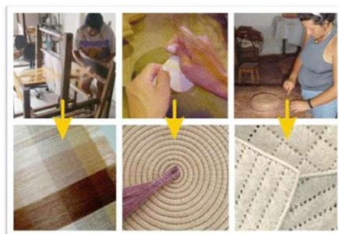
Cifra 01: Técnicas usado en producción en sisal de AALP: punto tejido, punto cerrado y punto de encaje.
