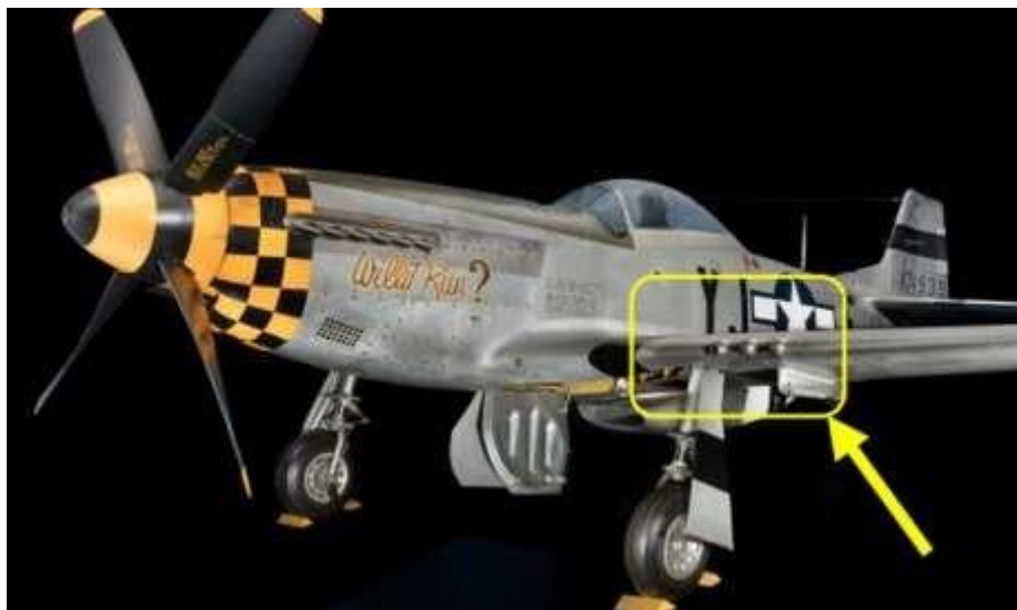
Figura 3 - Abertura das metralhadoras nas asas do P-51D
