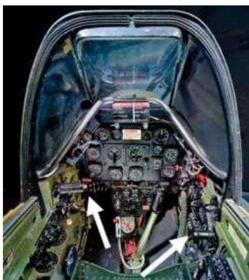
Figura 2 - Cabine de um P-51D. As setas mostram a manete de potência (esquerda) e manivela de abertura da capota (direita)
