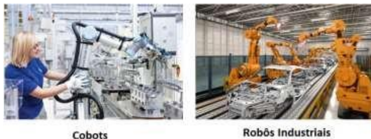
Figura 3 – Comparação entre COBOTS e Robôs Industriais
