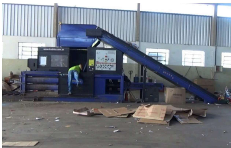
Figura 3 – Miembro de la cooperativa ajustando el material a presionar dentro de la máquina de prensado con la ayuda del tronco y las extremidades superiores Fuente: Autores
